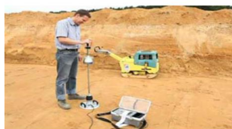
Zdjęcie 6: Badanie gruntu metodą płyty dynamicznej.
