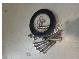
Materiał łączący połączenie kołnierzowe
