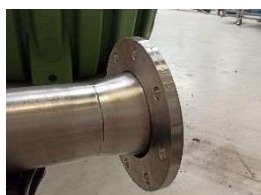
Kołnierz d140 RF gotowy do połączenia
