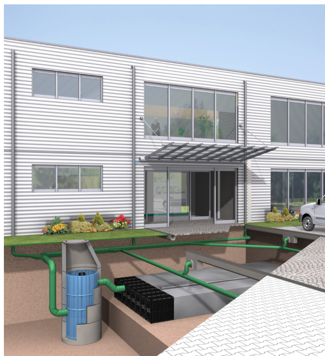
Rys. 7. Filtr usuwa zanieczyszczenia z dopływu do rygli skrzynkowej [11]
