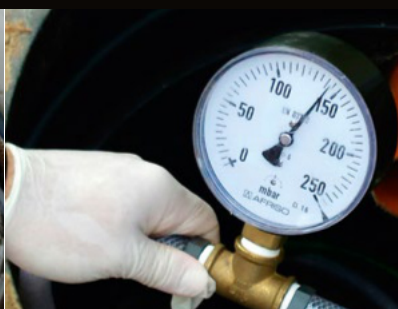
Badanie ciśnienia na układzie dmuchawa – dyfuzor napowietrzający
