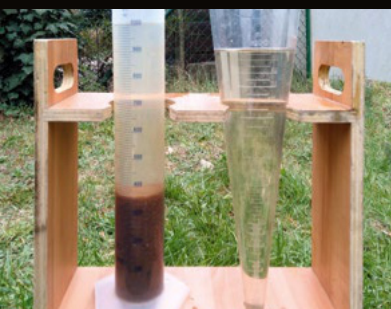
Próba sedymentacyjna osadu i ścieki oczyszczone
