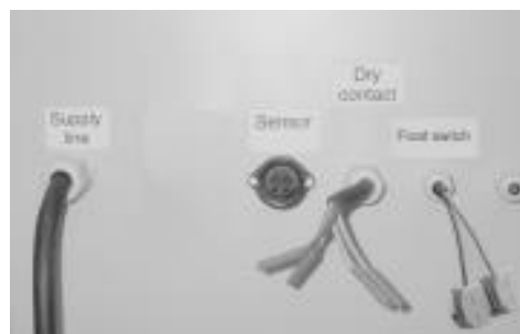
Rys. 4 Styk rozłączający – czarny Styk zamykający – brązowy Styk środkowy – szary
