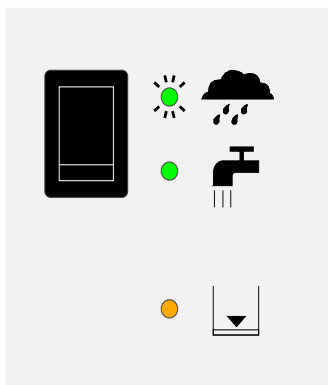
Tryb automatyczny „Woda deszczowa”
