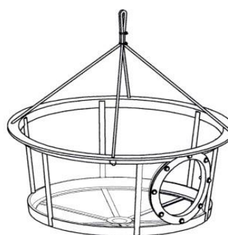
Filtr koszowy do wsunięcia na rurę dopływową
