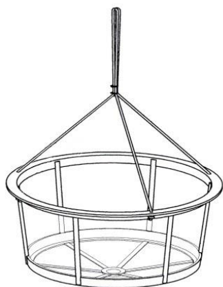
Filtr koszowy do podwieszenia pod rurą dopływową
