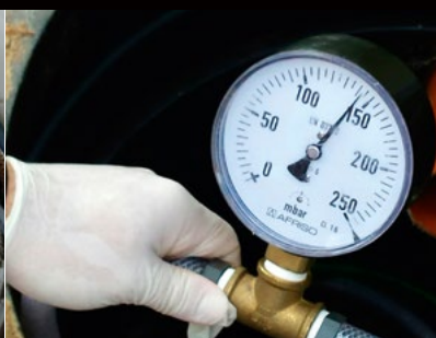
Badanie ciśnienia na układzie dmuchawa – dyfuzor napowietrzający
