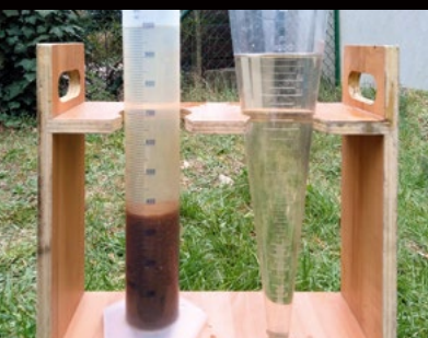
Próba sedymentacyjna osadu i ścieki oczyszczone
