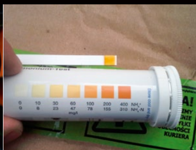
Test na zawartość azotu amonowego w ściekach oczyszczonych
