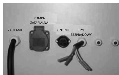
Rys. 2 Styk rozłączający – czarny Styk zamykający – brązowy Styk środkowy – szary
